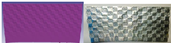
Рис. 3. Конечно-элементная модель процесса холодной прокатки алюминиевой полосы с исходным выпуклым поперечным профилем в комплекте валков с одним рифлёным валком
