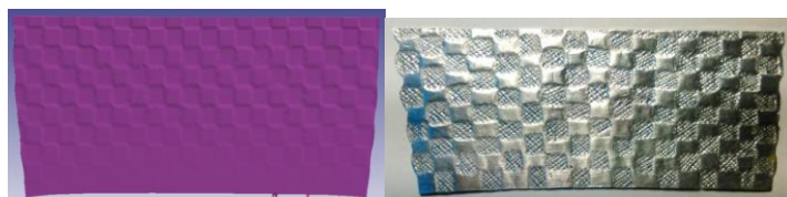
Рис. 3. Конечно-элементная модель процесса холодной прокатки алюминиевой полосы с исходным выпуклым поперечным профилем в комплексе валков с одним рифлёным валком
