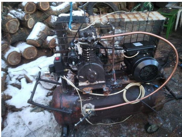
Фото 1. Вид компрессора из нестандартных составных частей
